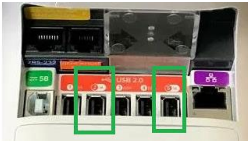
Рисунок 15. Разъёмы Эвотор 10: USB Type-C во 2-й или 5-й слот
